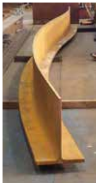
une des poutres découpées en T et cintrées au centre de fabrication Steligenz ® pour s'emboîter dans le pont
