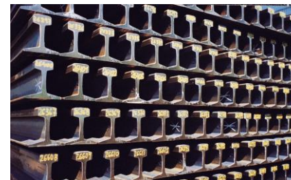
Rails pour pont roulant
