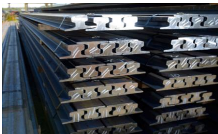
Rails de grue
